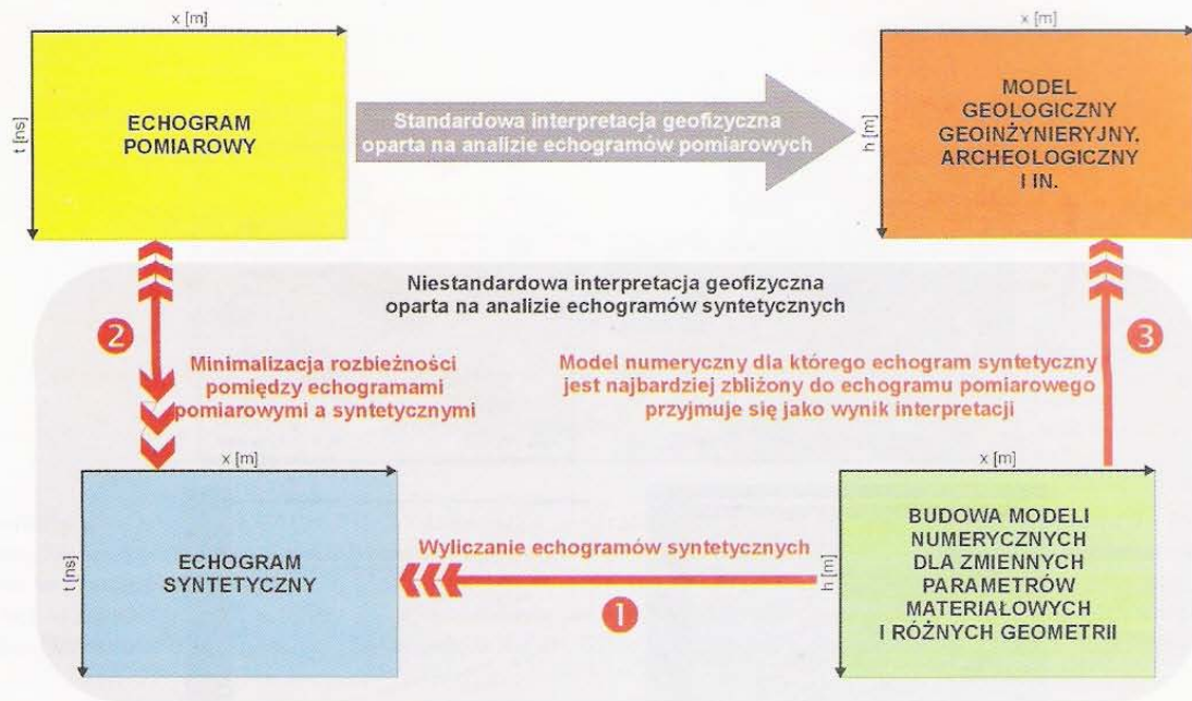
Rys. 5. Schemat prowadzenia interpretacji opartej na modelowaniu numerycznym pola georadarowego. Fig. 5. Schematic chart-flow for GPR interpretation based on numerical modelling.
