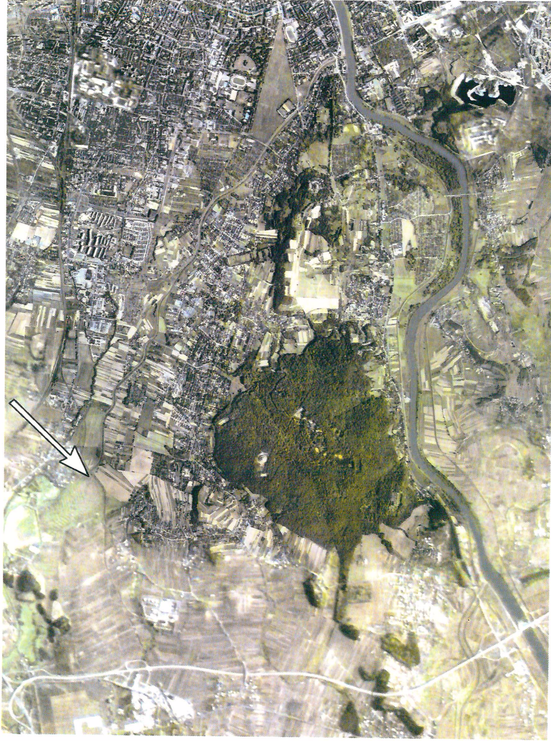
Rys. 1. Mapa fotograficzna wykonana przez kompilację zdjęć lotniczego i obrazu satelitarnego—część zachodnia jest obrazem zarejestrowanym z satelity, z wysokości kilkuset kilometrów, część środkowa i wschodnia powstała z przetworzenia zdjęcia lotniczego, wykonanego z wysokości kilku kilometrów (strzałka wskazuje jedno z miejsc połączenia informacji satelitarnej i lotniczej) Fig. 1. A photographic map compiled from aerial photos and satellite image. The left part was recorded by satellite from the altitude of several hundred of kilometers, while the middle and right parts come from aerial photos taken from the altitude of a few kilometers (arrow indicates a joint of the satellite and aerial images)
