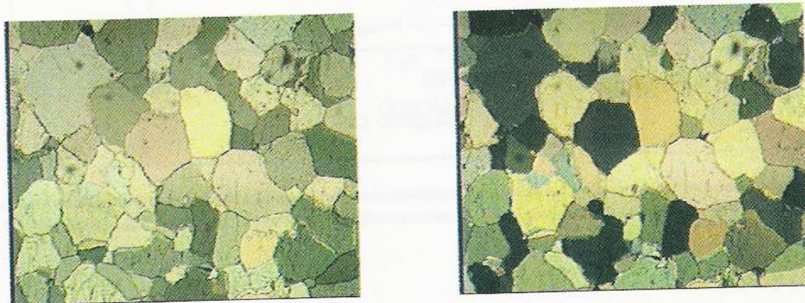
Rys. 2. Dwa obrazy tego samego pola zarejestrowanego przy 2 różnych kątach położenia polaryzatorów. Fig. 2. Two images of the same field registered in two different angle of position of the polarizers.
