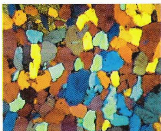
Rys. 7. Obrazy szlifu cienkiego piaskowca z Dąbek rejestrowane przy dwóch (a) i przy jednym (b) polaryzatorze. Fig. 7. Image of thin section of sandstone from Dąbki registered by means of two (a) and one (b) polarizers.
